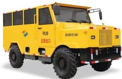
**RU-9无轨人车**主要适用于非煤矿山井下工作人员的接送。该车根据巷道作业的特点，采用先进的整体底盘设计，刚性和整车稳定性好。爬坡能力强，重载可达14°坡度。车桥采用湿式制动桥，承载力大，刹车安全可靠。排烟加装水过滤及化学净化装置，低碳环保。四轮独立弹簧板结构，减震效果好。变速机构采用电控液力机械传动装置，无级变速，驱动力大。液压转向，轻便灵活。人员乘用厢加固焊接，特别加厚板材，加粗加密安全支撑，防砸，安全性高。减震座椅，有安全带，厢内有软包隔音阻燃装饰，设有安全抓手，可加装空调，乘坐舒适。已取得国家《矿用产品安全标志证书》“KA”认证，产品符合国家关于安全、环保的政策要求。
