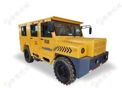
**RU-6无轨人车**主要适用于非煤矿山井下工作人员的接送。核载6人，该车根据巷道作业的特点，采用先进的整体底盘设计，刚性和整车稳定性好。爬坡能力强，重载可达14°坡度。车桥采用湿式制动桥，承载力大，刹车安全可靠。最小离地间隙240mm，通过性好。选用国三发动机，排烟加装水过滤及化学净化装置，低碳环保。四轮独立弹簧板结构，减震效果好，舒适度高。变速机构采用液力机械传动装置，无级变速，驱动力大。液压转向，轻便灵活。人员乘用厢加固焊接，加厚板材，加强安全支撑，防砸，安全性高。减震座椅，有安全带，厢内有软包隔音阻燃装饰，设有安全抓手，可加装空调，乘坐舒适。已取得国家《矿用产品安全标志证书》“KA”认证，产品符合国家关于安全、环保的要求。
