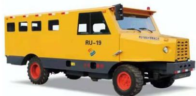
**RU-19无轨人车**主要适用于非煤矿山井下工作人员的接送。该车根据巷道作业的特点，采用先进的整体底盘设计，刚性和整车稳定性好。爬坡能力强，重载可达14°坡度。车桥采用湿式制动桥，承载力大，刹车安全可靠。排烟加装水过滤及化学净化装置，低碳环保。四轮独立弹簧板结构，减震效果好。变速机构采用电控液力机械传动装置，无级变速，驱动力大。液压转向，轻便灵活。人员乘用厢加固焊接，特别加厚板材，加粗加密安全支撑，防砸，安全性高。减震座椅，有安全带，厢内有软包隔音阻燃装饰，设有安全抓手，可加装空调，乘坐舒适。已取得国家《矿用产品安全标志证书》“KA”认证，产品符合国家关于安全、环保的政策要求。
