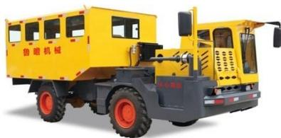
**RU-10无轨人车**主要适用于非煤矿山井下工作人员的接送。该车根据巷道作业的特点，采用先进的底盘设计，铰接式车架，液压转向机构，转弯半径小，操作灵活。四轮驱动，爬坡能力强，重载可达14°坡度。车桥采用湿式制动桥，承载力大，刹车安全可靠。排烟加装水过滤及化学净化装置，低碳环保。四轮独立弹簧板结构，减震效果好。变速机构采用双变结构，无级变速，驱动力大。人员乘用厢加固焊接，特别加厚厢板加厚顶板，加粗加密安全支撑，减震座椅，有安全带，厢内有软包隔音阻燃装饰，设有安全抓手，安全可靠，乘坐舒适。已取得国家《矿用产品安全标志证书》“KA”认证，产品符合国家关于安全、环保的政策要求。
